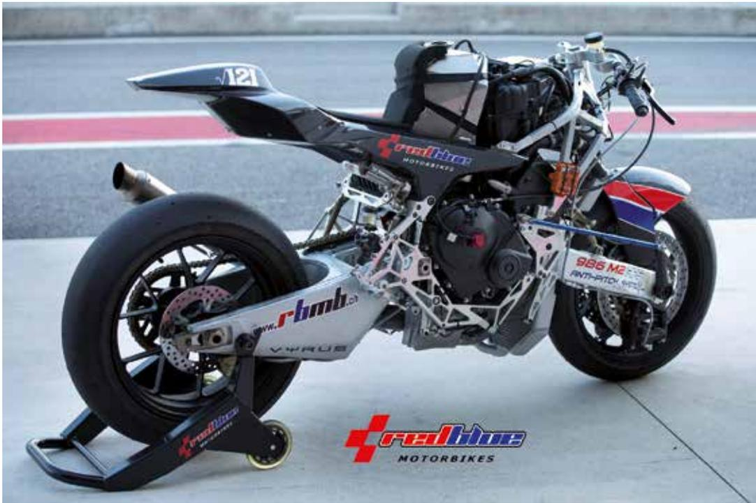
diatore installato al posteriore senza aumentare la superficie frontale della motocicletta avente un telaio perimetrale Delta-Box, è stata una sfida ingegneristica molto ardua. Ben più complessa di quella affrontata da John Britten con il bicilindrico a V. Senza ovviamente nulla togliere alla bellissima cre-
